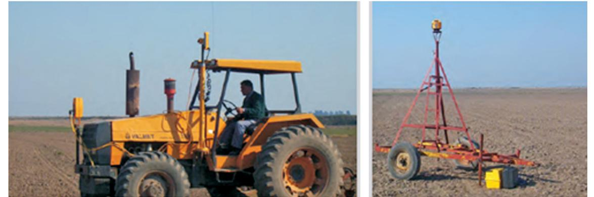
Figura 22. Marcación de taipas con nivel láser.
