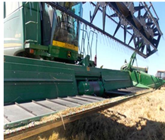
**Figura 40.** Cabezal con alimentación por draper
