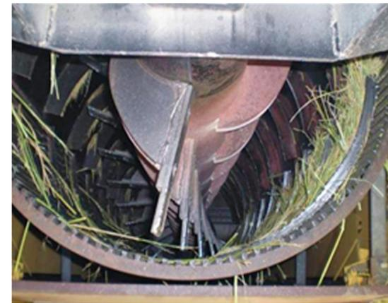
**Figura 41.** Sacapajas rotativos adaptados a las cosechadoras
